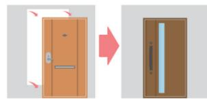
「はつり工法」とは、既存ドアを枠ごと取り外し、新たな枠を取り付け、ドアを交換する工事をいいます。
