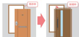
「カバー工法」とは、既存ドアについて枠を残して取り除き、既存枠の上から新たな枠を取り付け、ドアを交換する工事をいいます。
