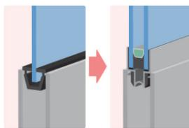
既存窓のガラスのみを取り外し、既存サッシをそのまま利用して、複層ガラス等に交換する工事をいいます。同じガラスであっても、既存サッシとの組み合わせにより、窓の性能区分が変わります。
