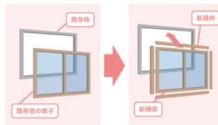
「カバー工法」とは、既存窓のガラスを取り外し、既存窓枠の上から新たな窓枠を覆い被せて取り付け、複層ガラス等に交換する工事をいいます。
